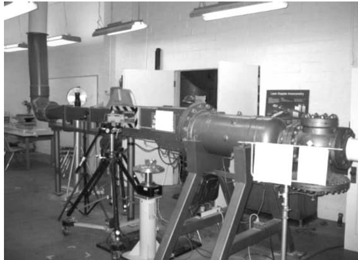
Рис. 1.21. Стенд для акустических испытаний микромеханических гироскопов
