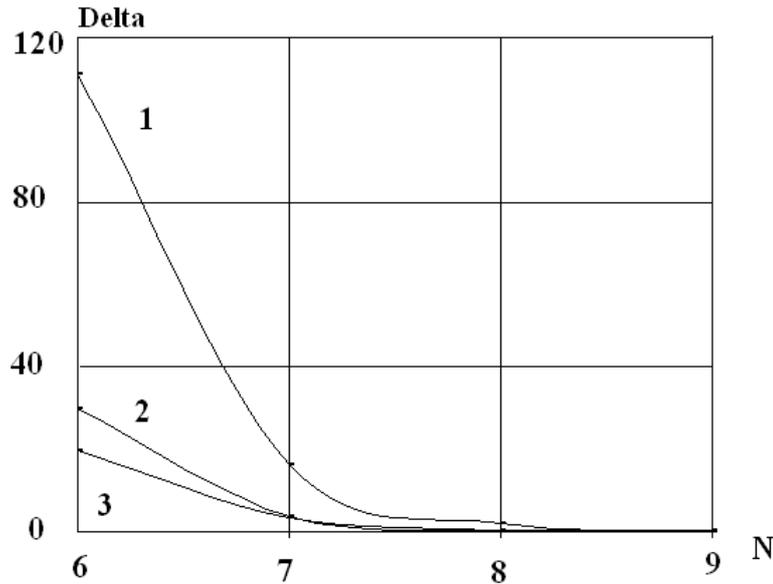
Рис.2. Зависимость абсолютного значения относительной погрешности определения нулевых сигналов от числа цифр после запятой в выходных сигналах акселерометров. Здесь кривые 1,2,3 соответствуют относительным погрешностям определения  $b_{ya}$ ,  $b_{xa}$ ,  $b_{za}$  в процентах
