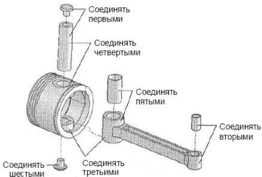
Рис. 7.3.5. Рекомендований порядок збірки
