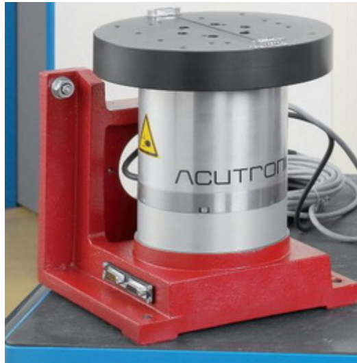
Рис.10.4. Автоматизированный поворотный стол AC1120-V1.0 фирмы Acutronic
