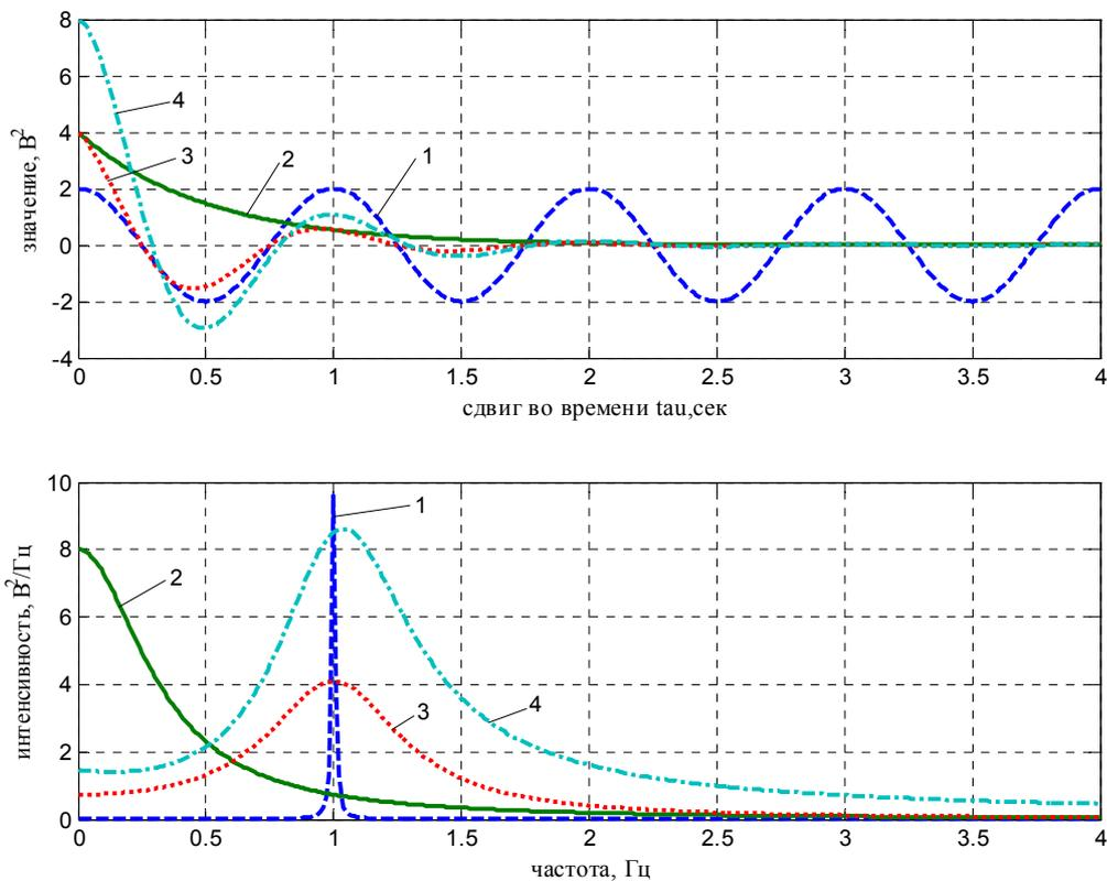
Рис.4. Односторонние корреляционные функции (сверху) и соответствующие им спектральные плотности
