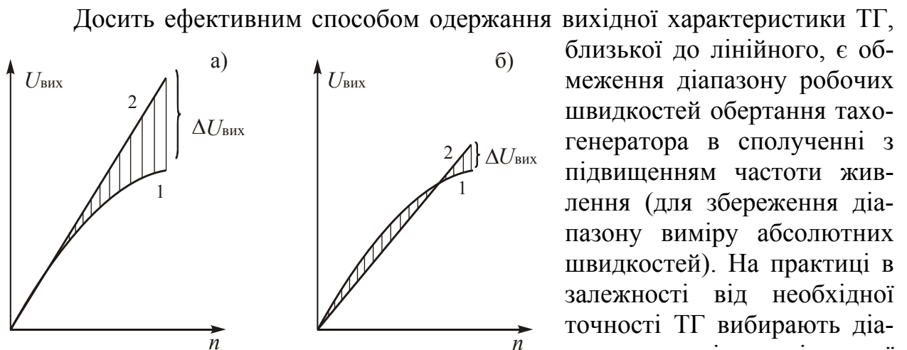
Рис. 8. Вихідні характеристики некаліброваного (а) та каліброваного (б) АТГ
