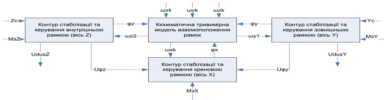
Рис.1 Структурна схема ММ ОГС на базі 3-х вісної стабілізованої платформи
