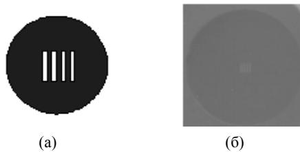
Рис. 1.5. Зовнішній вигляд 4-штрихової міри (а) і приклад ІЧ зображення (б)
