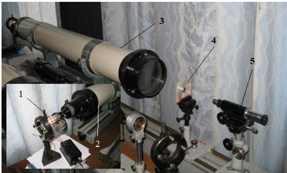
Рис. 4.14. Макет стенду для вимірювання ДЕ (позиції 6,7 не показані)
