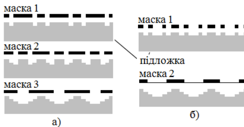
Рис. 1.9. Помилки виготовлення кіноформних елементів
