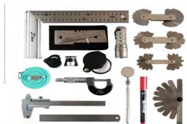
Рис.1 – Набір візуально-оптичного контролю
