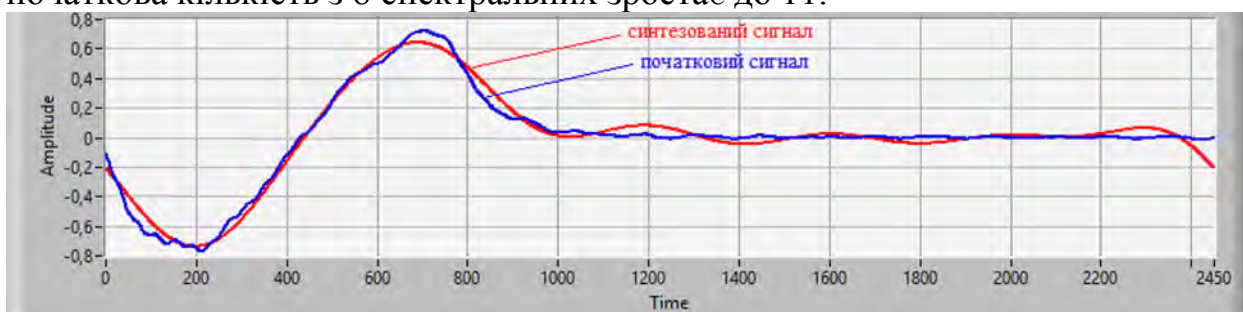
Рисунок 4. Початковий та синтезований по восьми спектральним складовим інформаційні сигнали
