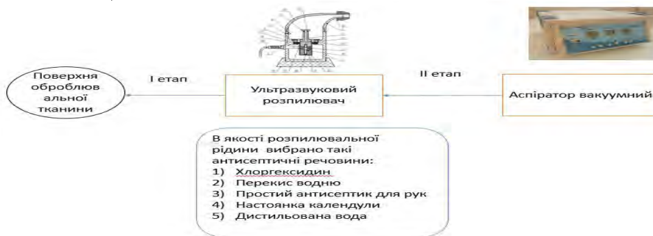
Рисунок 2. Структура етапів схеми очищення
