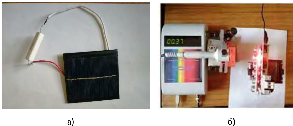
Рис. 1. Загальний вигляд сонячного елемента з контрольним резистором (а) та стенду для вимірювання потужності світла (б).
