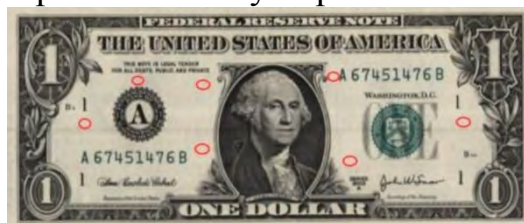
Рисунок.1. Зображення контрольних точок, за якими відбувається вимірювання оптичної щільності.
