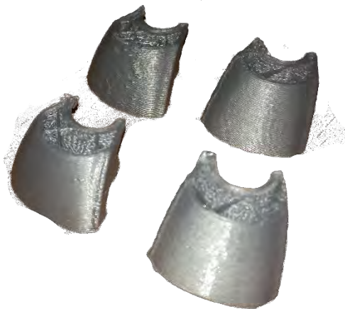
Рис. 3. Деталі, що відклеїлися в процесі друку
