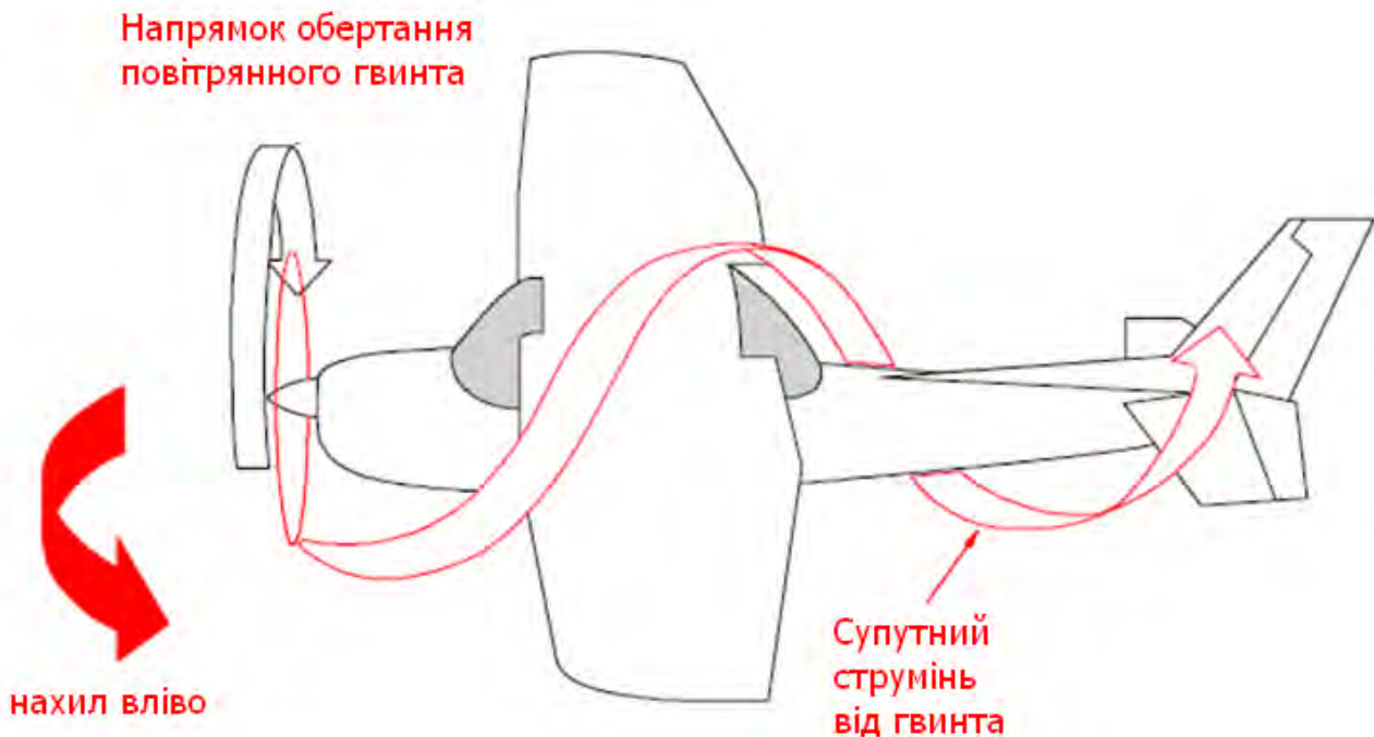
Рисунок 2. Зображення бічної сили при використанні тягне гвинта.
