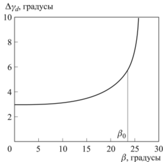
Рис. 3.5. Залежність кутового діапазону розгортки \Delta\gamma_d АОД від кута падіння променя на вихідну грань дефлектору \beta
