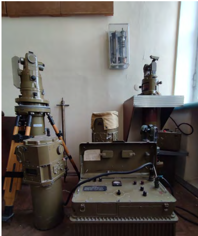
Лабораторна установка для ознайомлення та дослідження роботи гіроскопічних курсових систем на основі гіроскопів напрямку. Стенд містить гіронапівкомпас ГПК-52, датчик кутової швидкості ВК-58РБ та пульт керування
