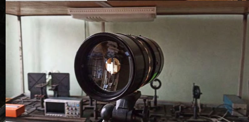
Телевізійна система спостереження з фокусною відстанню 1000 мм
