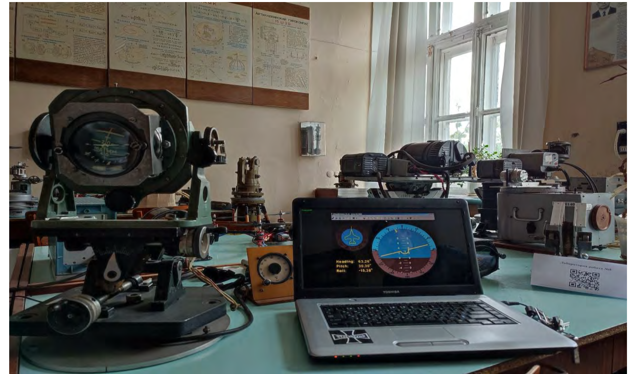
Стенд для дослідження простих авіаційних горизонтів, особливостей їх побудови та роботи на прикладі приладу АГІ-1
