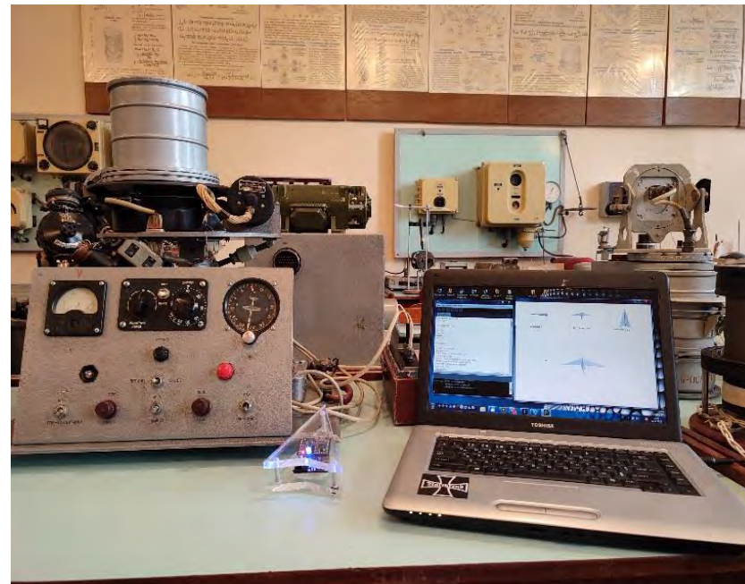
Лабораторна установка для ознайомлення та дослідження роботи гіроскопічних курсових систем на основі гіроскопів напрямку. Стенд містить гіронапівкомпас ГПК-52, датчик кутової швидкості ВК-58РБ та пульт керування
