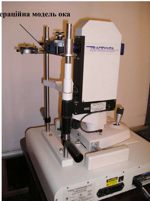
Рис. 9.27. Модель ока, що встановлена на аберометрі рейтресингового типу іTrace (Tracey Technologie) для його калібрування
