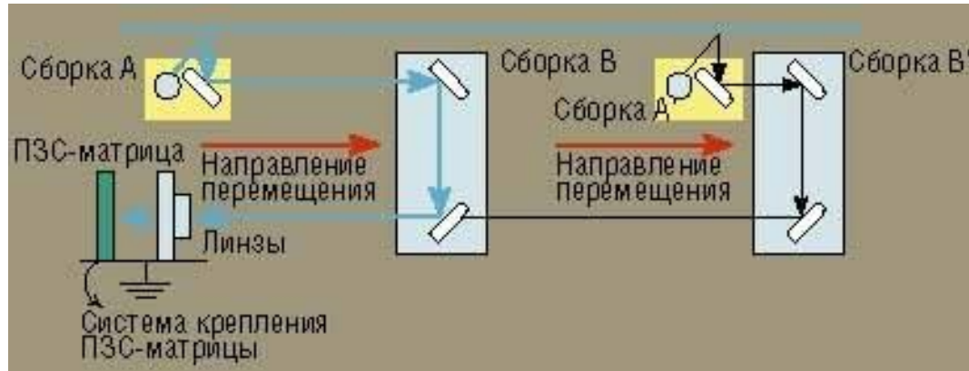
Рис. 1.19. Принципова схема механізму PowerLook 2100XL
